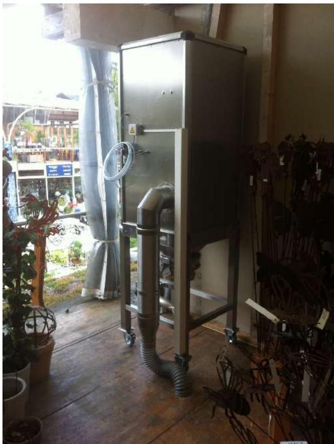
*Пример монтажа установки на втором этаже над зоной удаления мучной пыли*
