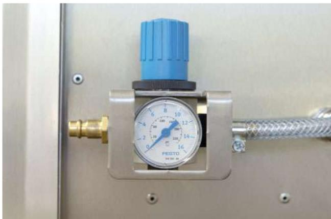
*Манометр с влагоотделителем для подключения сжатого воздуха*
